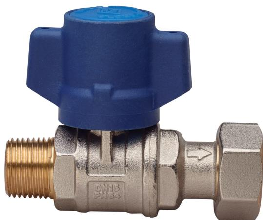
Valvola a sfera per acqua per ingresso contatore, a passaggio totale, filettatura maschio/girello, ritegno incorporato, con farfalla antimanomissione e **dado di sicurezza in acciaio inox a profilo eptagonale**, sfera con sistema di risciacquo automatico.
