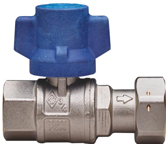
Valvola a sfera per acqua per ingresso contatore, a passaggio totale, filettatura femmina/girello, con farfalla antimanomissione e **dado di sicurezza in acciaio inox a profilo eptagonale**, sfera con sistema di risciacquo automatico.
